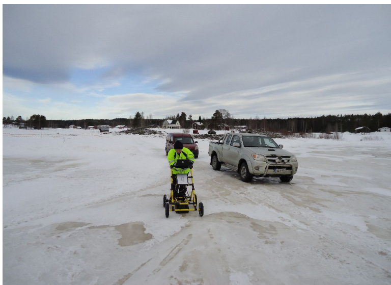
Рисунок 3. Сбор GPR данных по ледяной дороге
