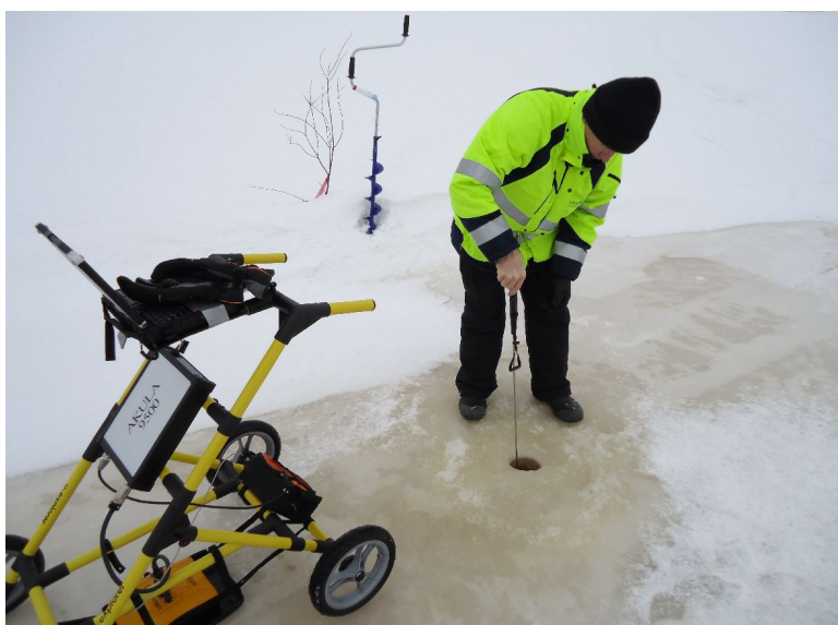
Рисунок 4. Измерения калибровочного отверстия
