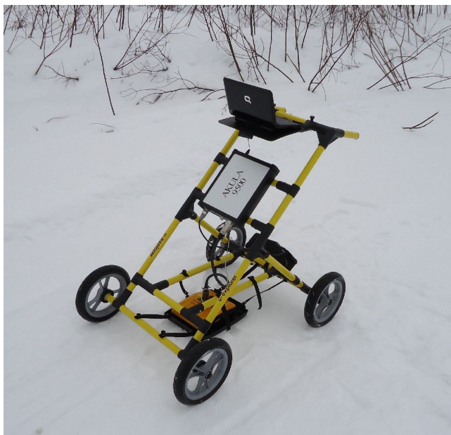
Рисунок 2. GCB1000, смонтированная на стандартную тележку SVC820
