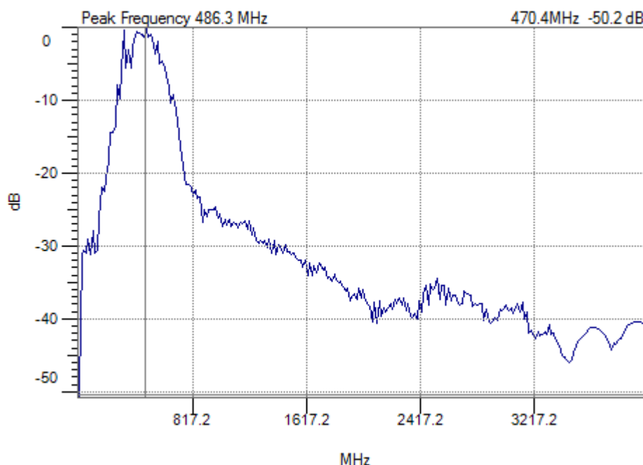
Рис.2 Спектр мощности грунтопроникающей антенны GCB-500.
