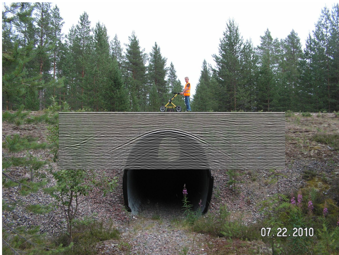
Рис. 5 Комбинированная фотография, отображающая область исследования и наложенные данные GCB-500.
